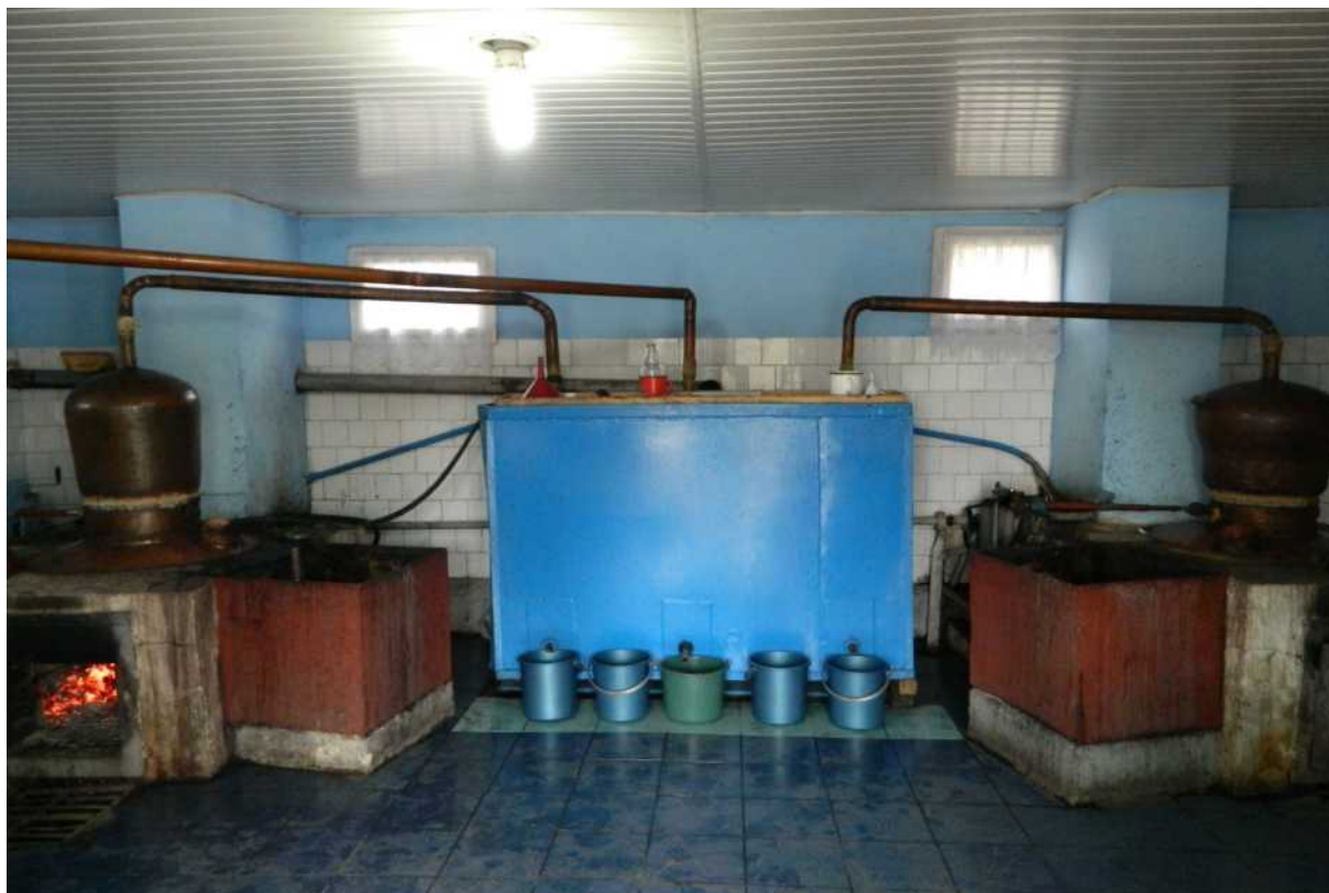
Anul 2020. Vedere interioară a „fabricii de țuică” de la Aldești. Sunt prezentate 2 „cazane” și răcitorul lor.
