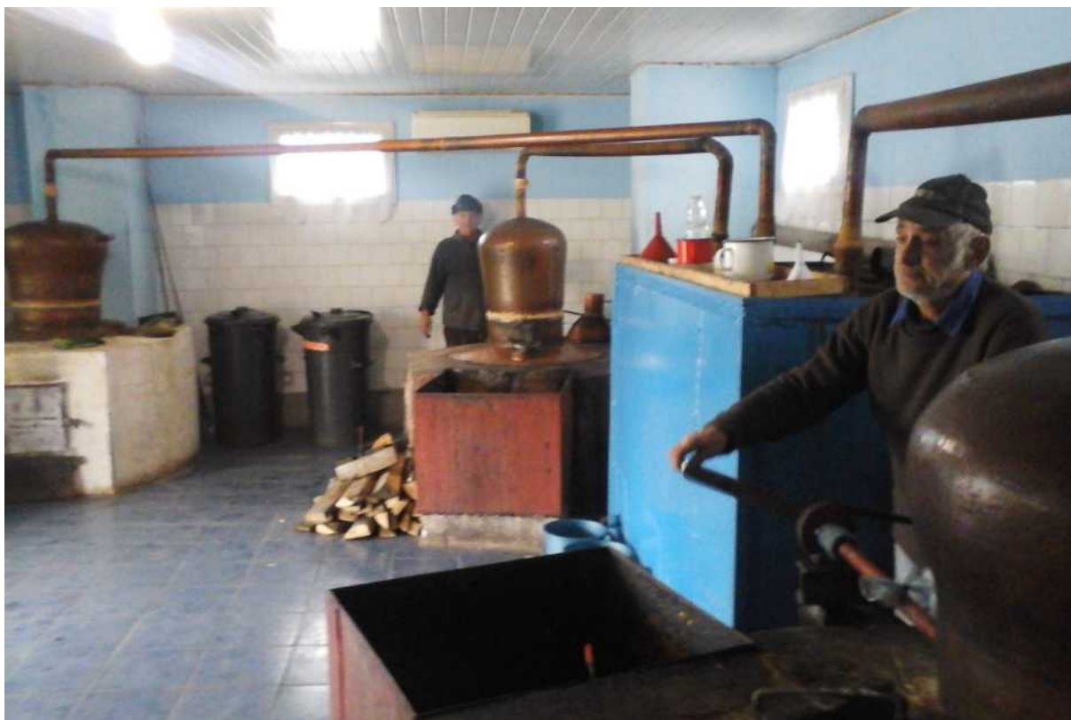
Anul 2020. Interior al „fabricii de țuică” de la Aldești, vedere care cuprinde toate 3 (trei) cazanele, două cazane care „fierb” fructele fermentate și unul pentru distilarea a 2-a („întors țuica”).
